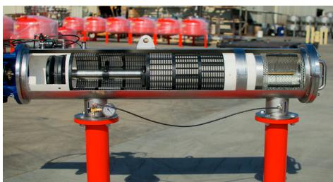
Las secciones de la malla se ensamblan fácilmente entre si permitiendo que el cambio de cartucho sea mucho más fácil.
